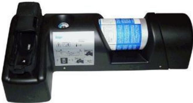
Gasmessgeräte sind 1x pro Monat sowie nach jedem Gebrauch einer Funktions- und Anzeigenkontrolle unter Prüfgas zu unterziehen.
